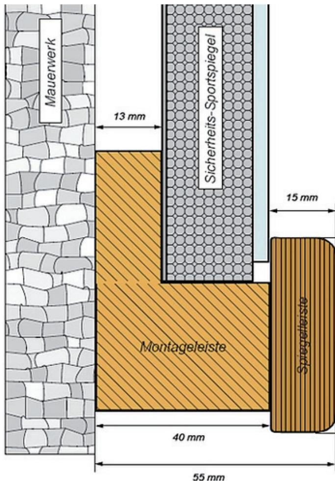
Zur Montage der Spiegelwand KRISTALL benötigen Sie die passenden Montageleisten, Blendleisten und Spiegelleisten.
